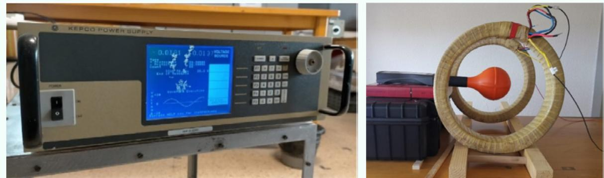
**Figura 2.** Fuente de alimentación Kepco BOP 2050 MG (izqda.) y bobinas de Helmholtz (drcha.) empleadas en la intercomparación de los medidores de campo electromagnético en el laboratorio del Instituto de Magnetismo Aplicado de la UCM.
