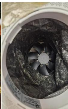
**Figura 5.** Ventilador de la trampa CDC y BG-Sentinel, respectivamente.
