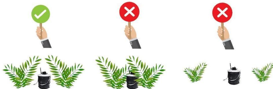
**Figura 1.** Esquema a la izquierda de una trampa tipo Bg-Sentinel situada correctamente en una zona con cobertura vegetal dejando libre la zona superior para que los mosquitos puedan acercarse con facilidad a la zona de succión de la trampa. En el centro, un emplazamiento inapropiado por exceso de vegetación sobre la apertura de la trampa. A la derecha, un emplazamiento inapropiado por falta de cobertura vegetal.
