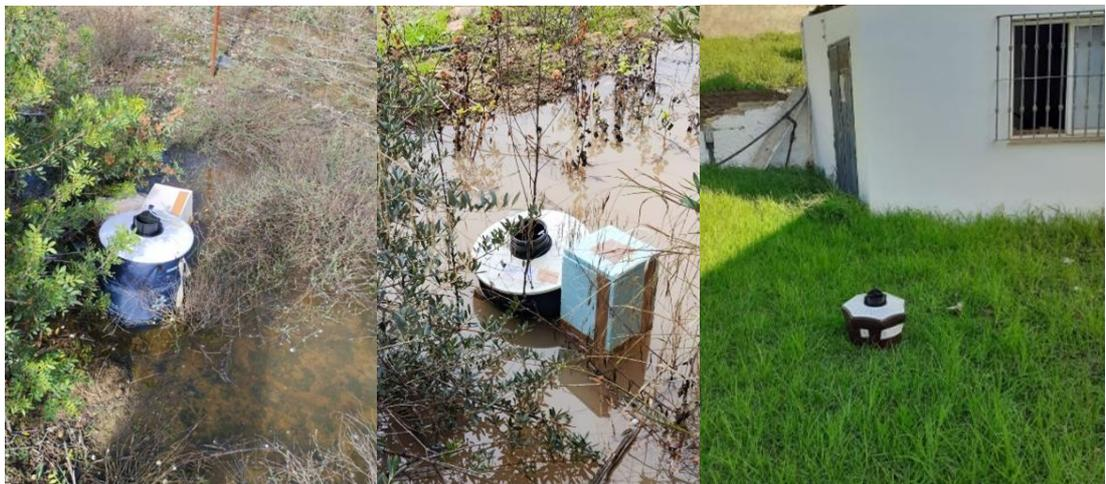
**Figura 3.** Ejemplos de emplazamientos inadecuados de trampas. En las dos primeras fotografías, la trampa (modelo BG-Sentinel) está localizada en una zona de inundación y en la segunda fotografía la trampa (modelo Mosquitaire) está expuesta sin protección vegetal en medio de un jardín.
