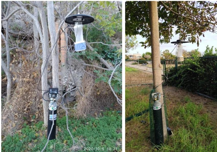
**Figura 9.** Trampas CDC equipadas con bombonas de CO<sub>2</sub>.
