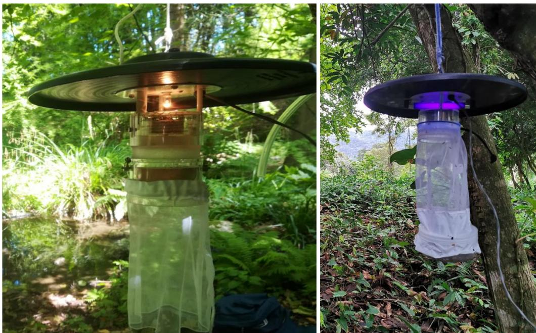
**Figura 7.** Modelos de trampa CDC de origen americano. A la izquierda con luz incandescente y a la derecha con tubo de luz fluorescente (UV/negra).
