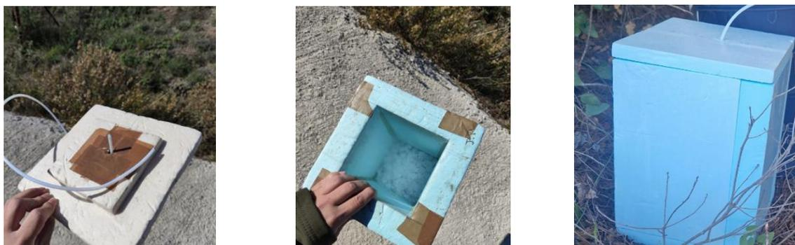
**Figura 8.** Caja de poliestireno de 5 cm de grosor con una salida en la parte superior conectada a un tubo de PTFE de 2 mm de diámetro interno.
