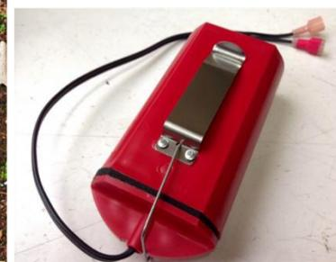
**Figura 6.** Ejemplo de batería de plomo (12V) y dispositivo de pilas alcalinas para alimentar con energía las trampas de succión.
