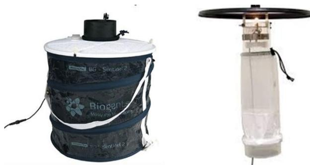
**Figura 4.** Modelos de trampas más empleados para la captura de mosquitos. Modelos BG-Sentinel y CDC, respectivamente.
