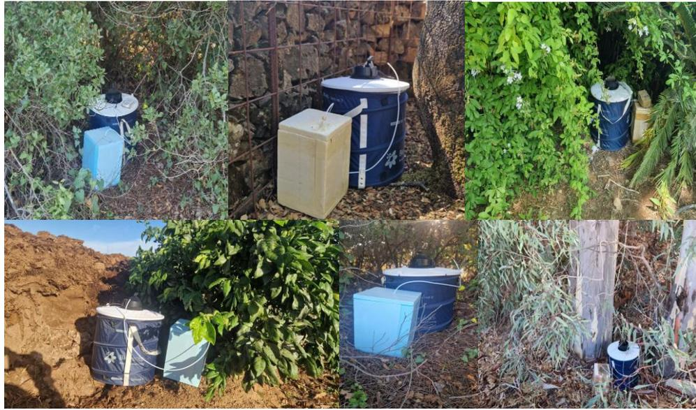
**Figura 2.** Imagen de emplazamientos adecuados típicos de trampas de tipo BG-Sentinel con diferentes tipos de cobertura vegetal o protección frente al viento.
