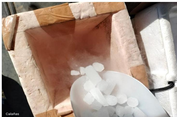
**Figura 15.** Colocación de hielo seco en forma de pellets en la caja de poliestirén.
