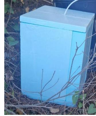
**Figura 8.** Caja de poliestireno de 5 cm de grosor con una salida en la parte superior conectada a un tubo de PTFE de 2 mm de diámetro interno.
