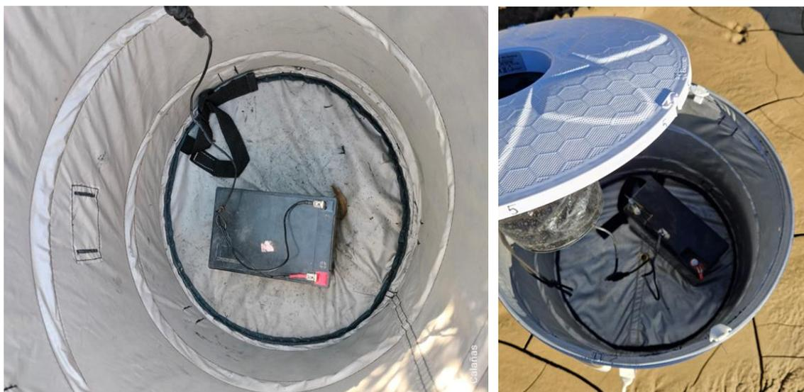
**Figura 13.** Colocación de la batería en el interior de la trampa BG-Sentinel.
