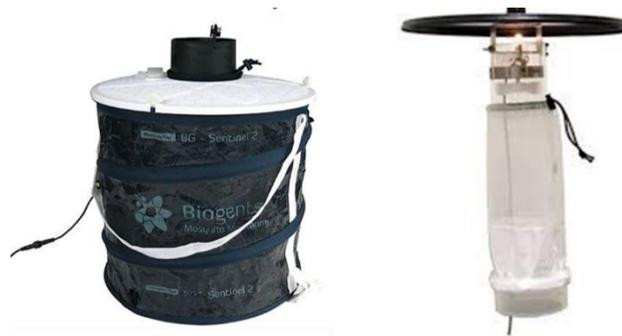
Figura 4. Modelos de trampas más empleados para la captura de mosquitos. Modelos BG-Sentinel y CDC, respectivamente.
